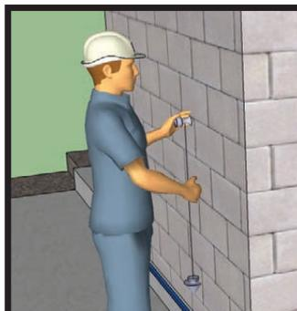
Antes de instalar sobre una pared de concreto la Fachada Tek, es necesario asegurarse que se encuentre la superficie aplomada y uniforme, para evitar deformaciones en el producto y alteración del acabado.
