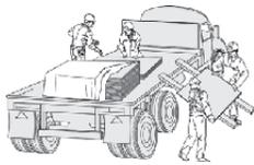
La Fachada Tek debe ser transportada en una plataforma firme y plana, con protección contra la humedad.
