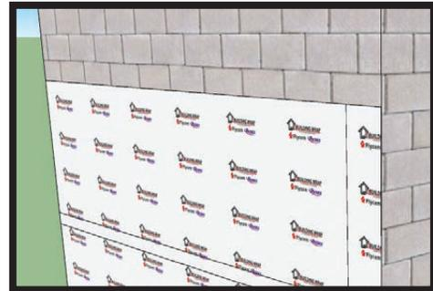
Instale sobre la barrera de humedad los clips de arranque @ 61 cm y comience a colocar las piezas de Plydekor de izquierda a derecha de abajo hacia arriba. Ponga una fila de clips sobre el siding colocado y continúe con el proceso.
