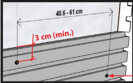
Tornillo PH 8-225 colocado en posición alterna.
