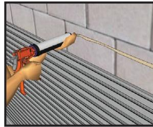
Instale cada pieza de Plydekor aplicando previamente un cordón de Sikaflex 221 o similar en la misma dirección de la pieza Plydekor. Luego sostenga la pieza mientras se seca el Sikaflex, usando un clavo de acero fijo temporal, o permanente.
