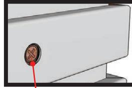
La cabeza del tornillo ubicada 2mm por debajo de la superficie. (usar tornillo PH 8-225).
